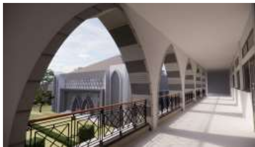
Gambar 1.4 Penerapan Desain koridor dan jendela yang lebar akan memberikan keleluasaan terhadap masuknya cahaya dan udara kedalam ruangan serta kenyamanan pengguna
